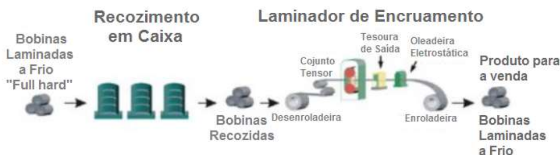
Figura 4 - Processo Produtivo de Bobinas Laminadas a Frio
