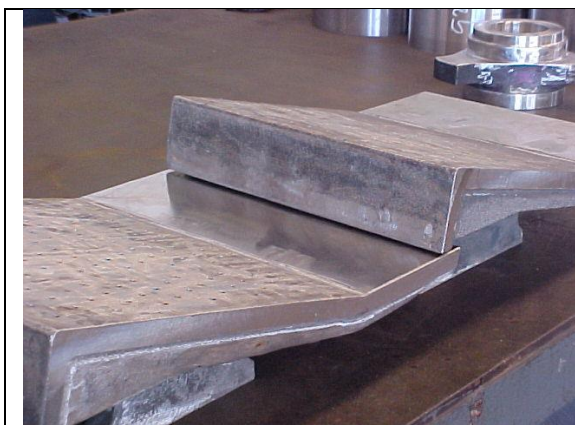
Figura 33 – Grelha com as laterais usinadas Fonte: Aatoria própria.
