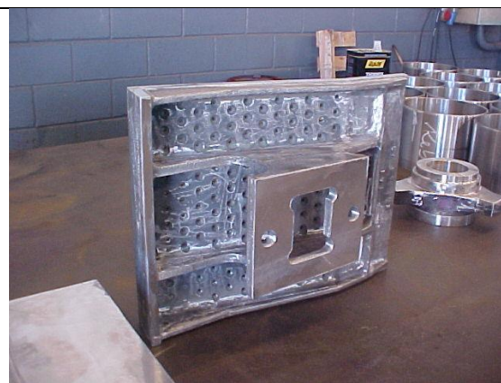
Figura 34 – Grelha com o assento usinado Fonte: Aatoria própria.
