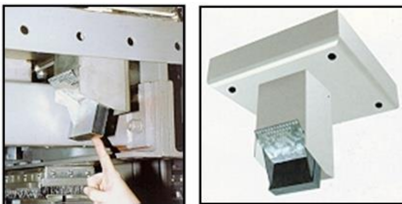
Figura 54 – Regulagem mecânica do fluxo de ar Fonte: Votorantim Cimentos – Programa Trainee (2000)
