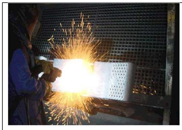
Figura 40 – Revestimento de grelha com arc spray Fonte: Eutectic (2012).
