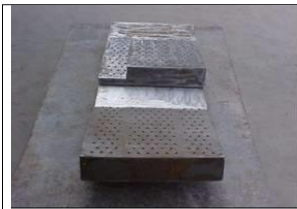
Figura 35 – Grelha com rebaixo e sem revestimento em “X” Fonte: Aatoria própria.
