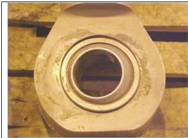
Figura 19 – Braço de acionamento da grelha deformado Fonte: Autoria própria.
