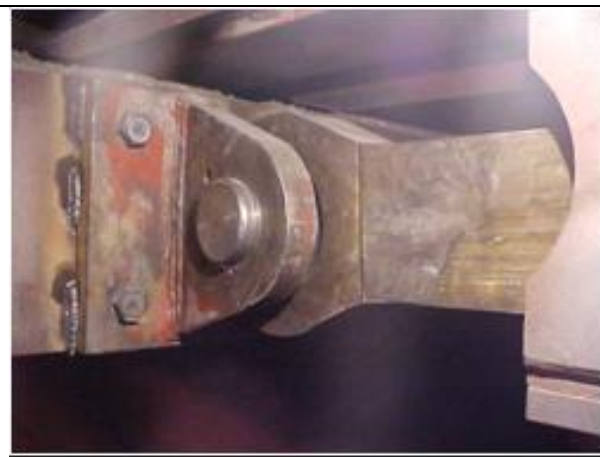
Figura 20 – Suporte e braço de acionamento novo Fonte: Autoria própria.
