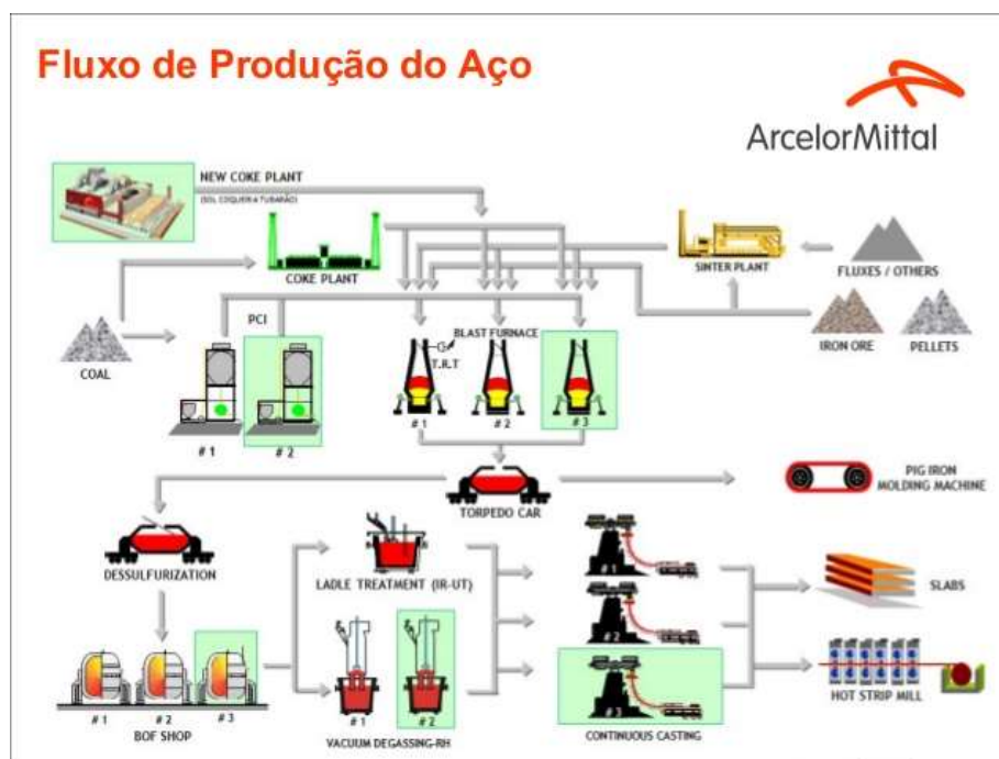
Figura 2.2 – Fluxo de Produção de Aço da Arcelormittal Tubarão
