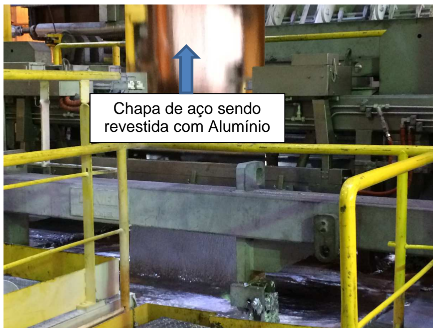
Fotografia 2.2 – Processo de Revestimento com Alumínio de uma Chapa de Aço
