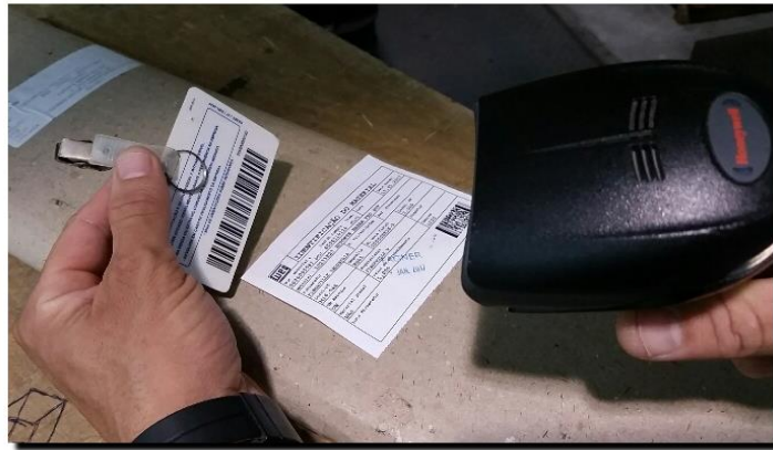
Figura 10 - Leitura do código de barras do material e do crachá de identificação do colaborador Fonte: WEG (2016).
