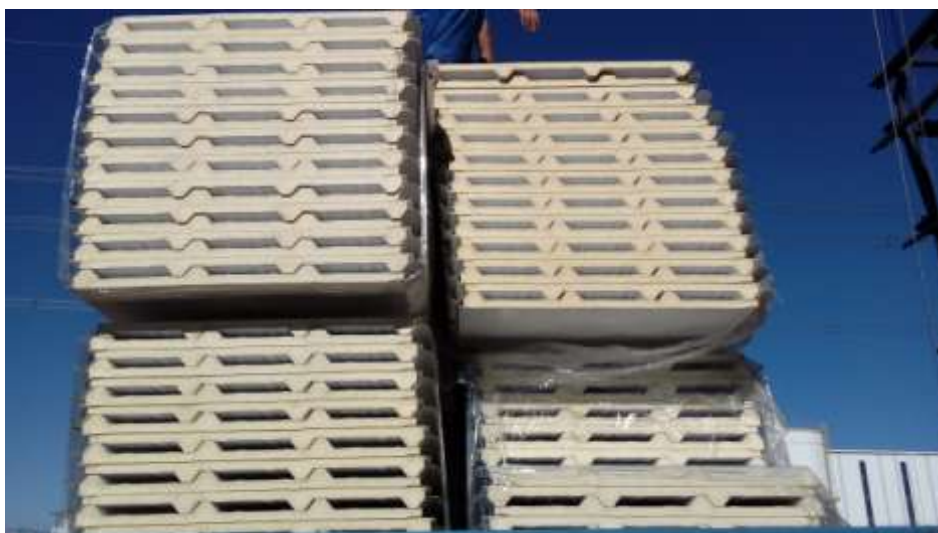
Figura 5 - Carga mal acomodada no caminhão. Fonte: O autor, 2016.
