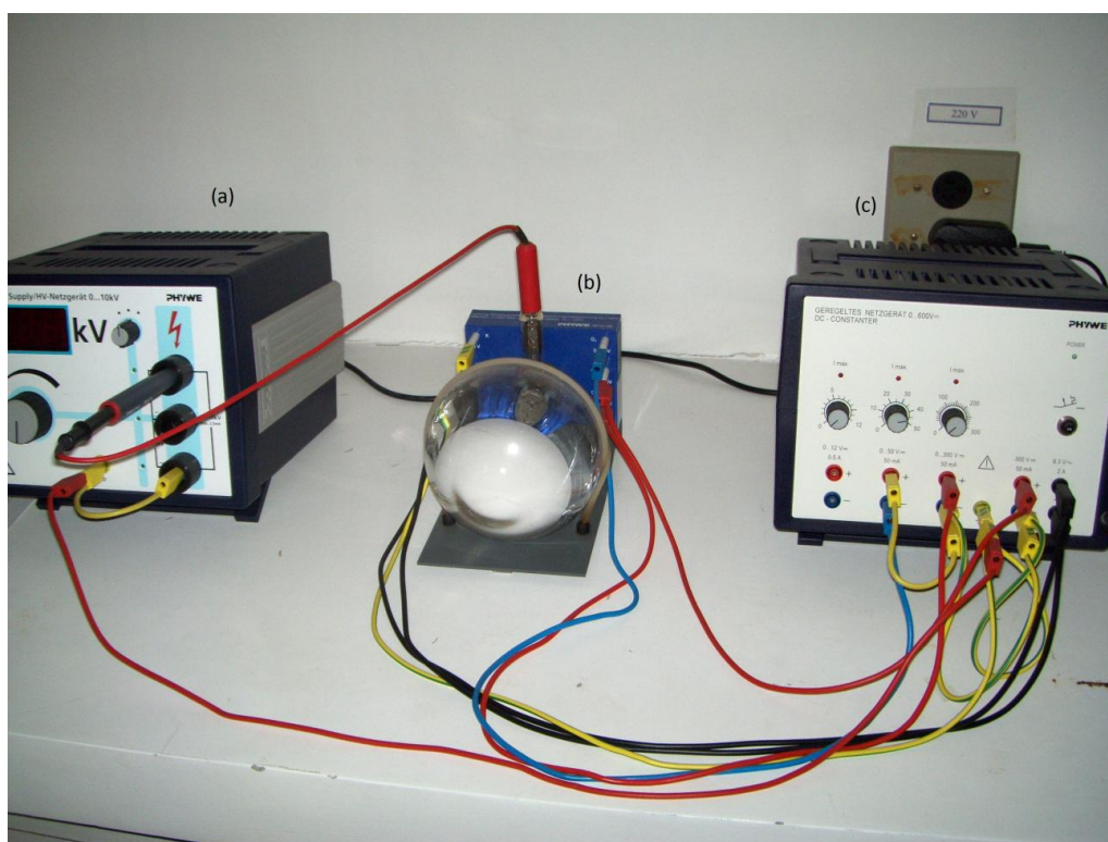
Figura 13 - Experimento didático da difração de elétrons: (a) Fonte de tensão; (b) Tubo de difração de elétrons com suporte; (c) Alimentação regulável de energia. Fonte: Autor (2015)
