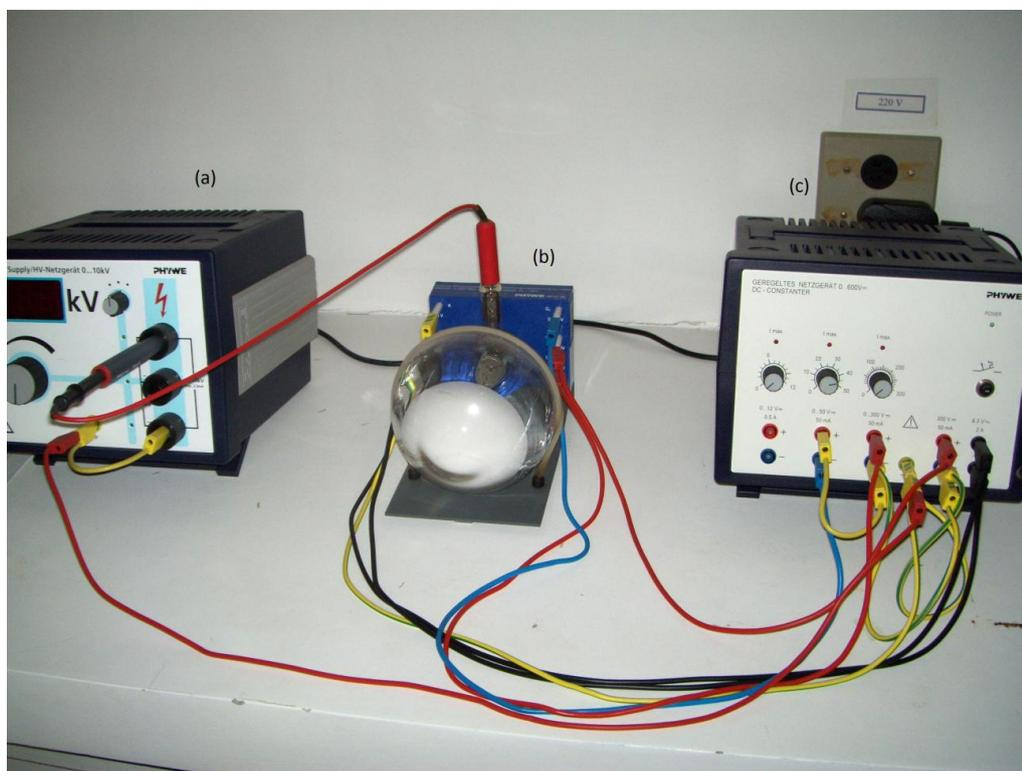
Figura 1 – Experimento da difração de elétrons
