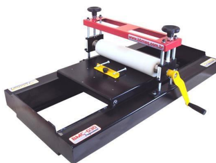
Figura 1 – Foto da máquina manual de corte e vinco atualizada
