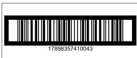
Figura 4 – Exemplo do código de barras EAN-14
