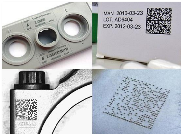
Figura 11 – Utilização do código GS1 DataMatrix
