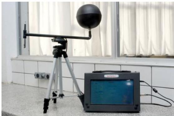
**Figura 21 - Confortímetro Senu®**
