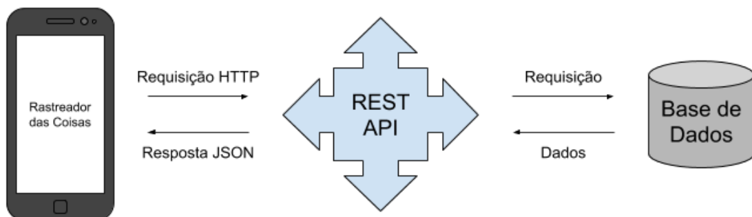
Figura 18 – Trocas de requisições e respostas entre o aplicativo e a base de dados
