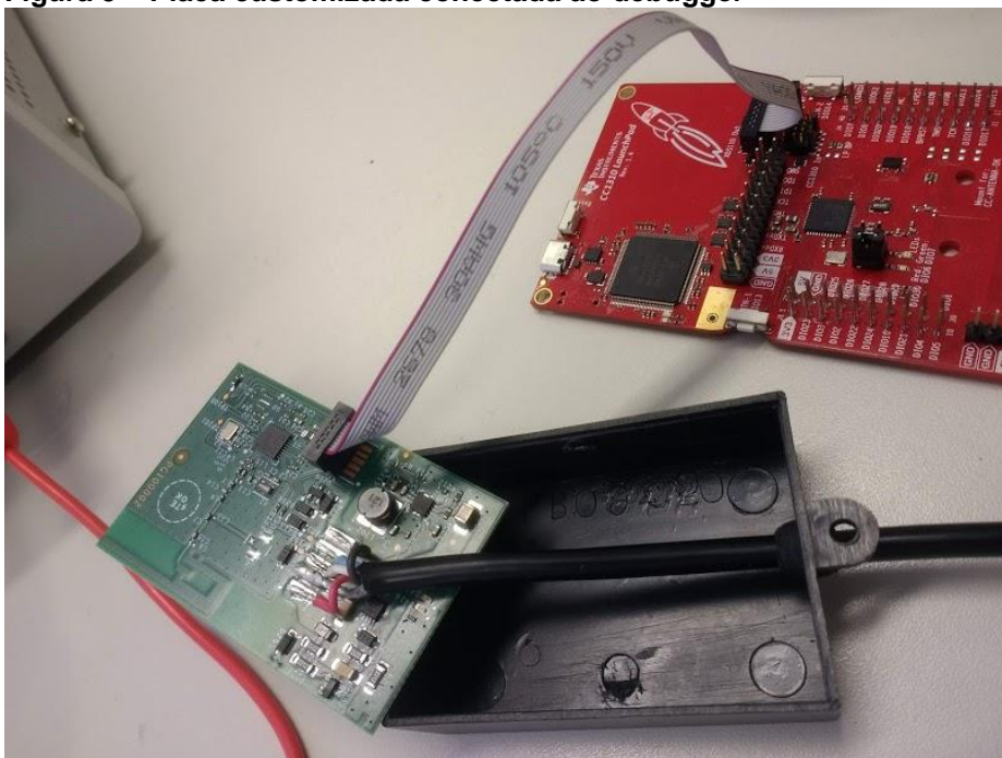
Figura 9 – Placa customizada conectada ao debugger
