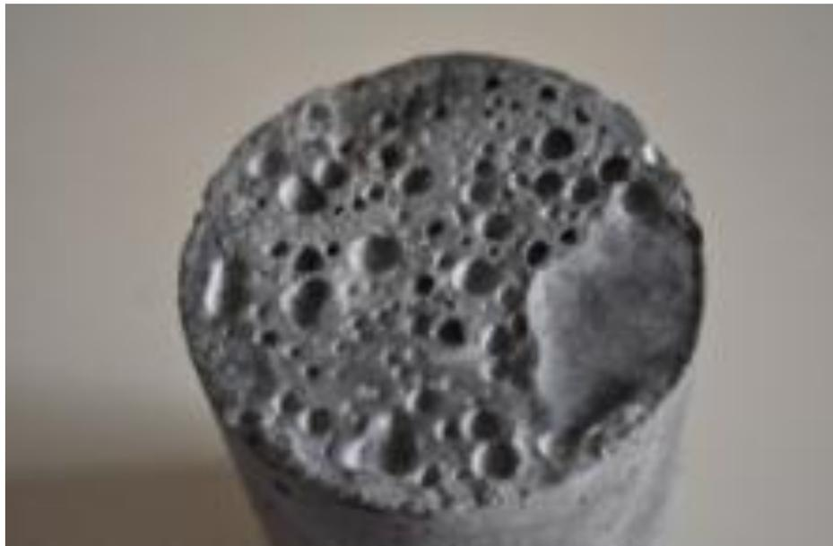
Figura 21 - Bolhas no topo do corpo de prova CPR
