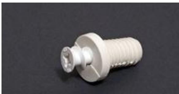
Figura 20 - Tampão utilizado no ensaio de permeabilidade à água e ao ar
