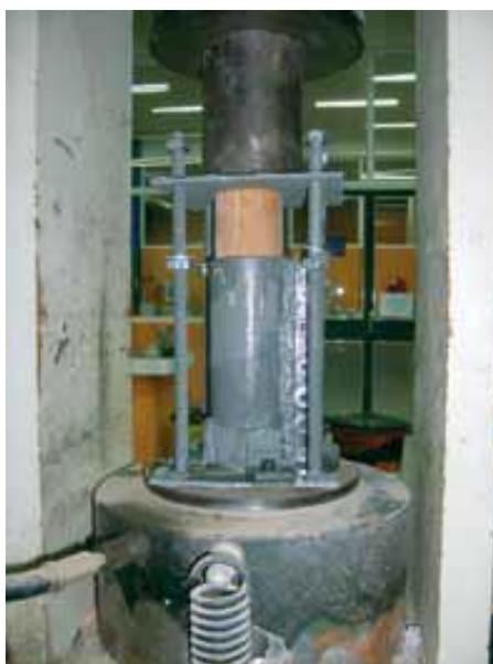
Figura 8 - Aplicação de pressão no CPR
