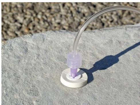
Figura 19 - Ensaio de permeabilidade ao ar
