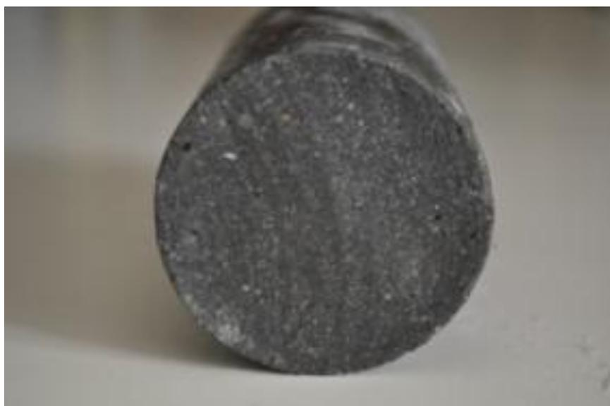
Figura 22 - Aspecto da seção do corpo de prova CPR rompido e retificado
