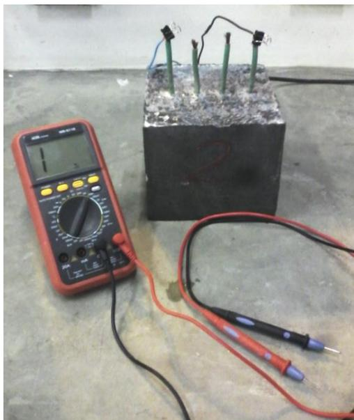
Figura 17 - Ensaio de resistividade elétrica
