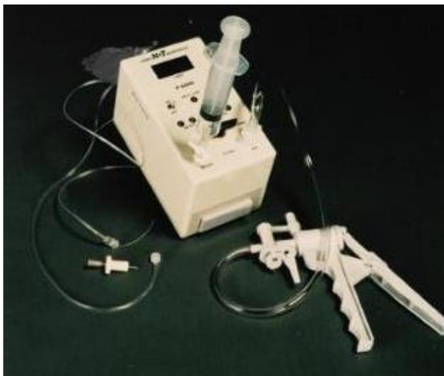
Figura 18 - Poroscope™ utilizado no ensaio de permeabilidade
