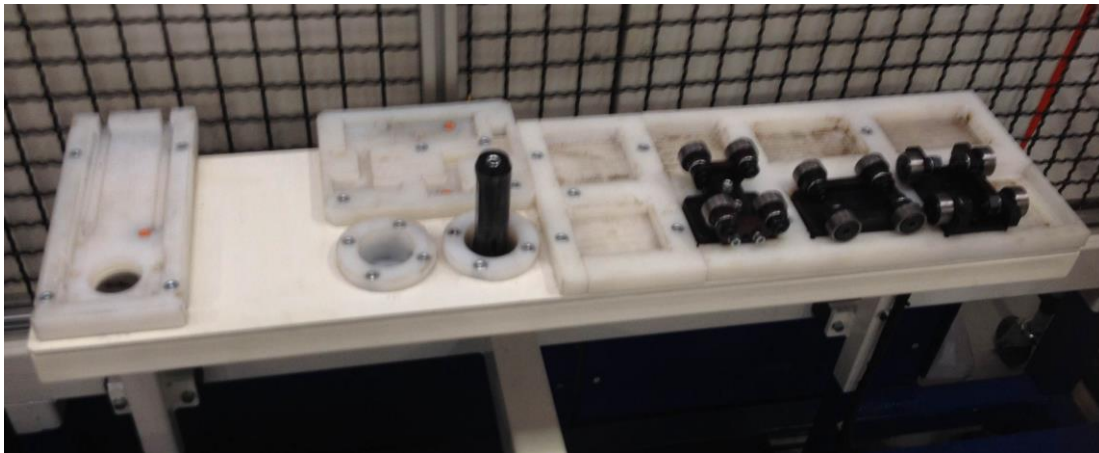
Figura 6 – Foto de berço monitorado por sensores indutivos Fonte: Autoria própria
