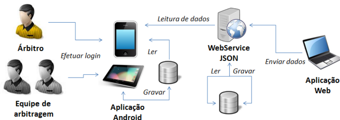
Figura 11 - Diagrama de fluxo básico do aplicativo "Soccer Referee".
