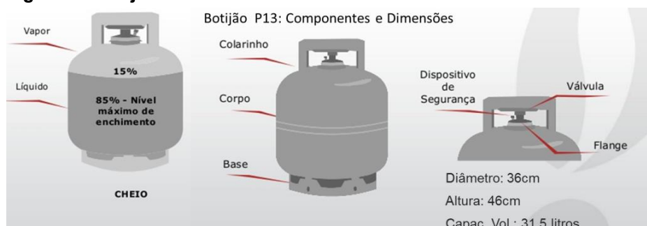
Figura 1 - Botijão P13 volumetria do GLP
