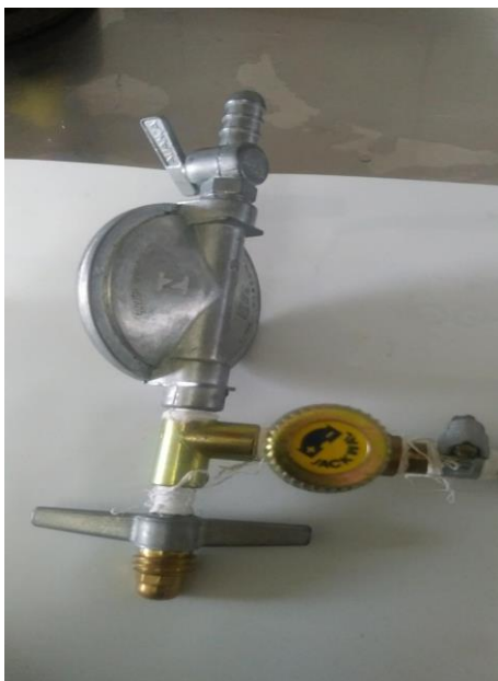
Figura 10 - Regulador de pressão com inserção de uma derivação para conexão para sensor de pressão MPX 5700AP
