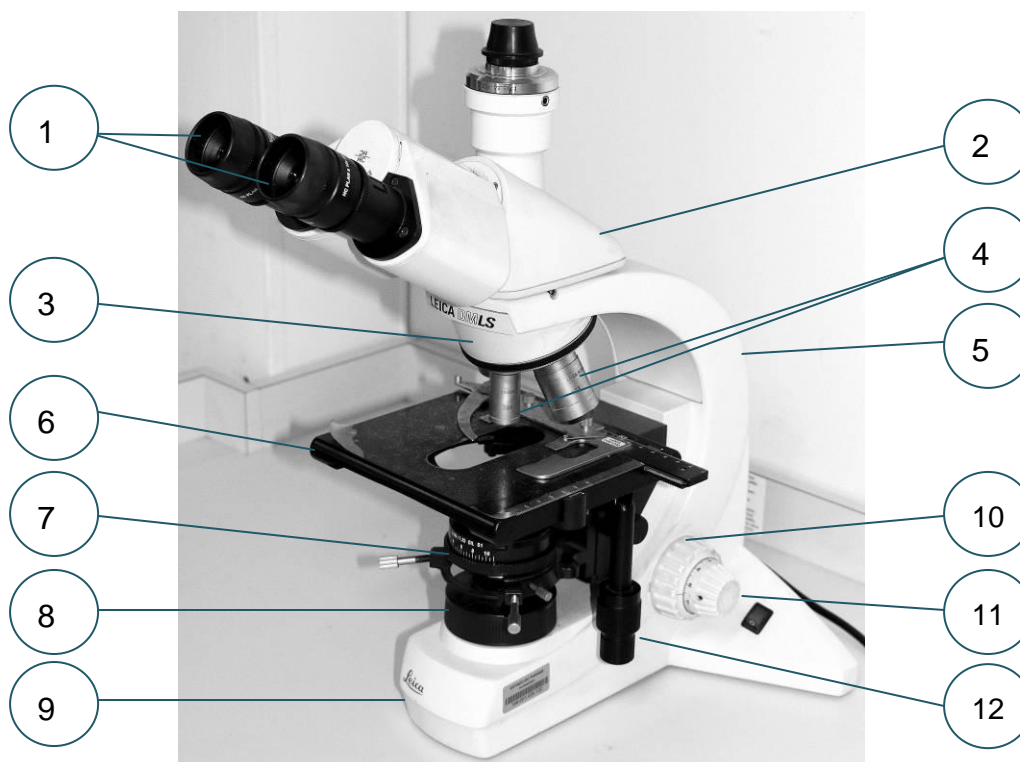
Figura 1 - Estrutura básica de um microscópio óptico. Fonte: Adaptado de Casartelli, 1968.
