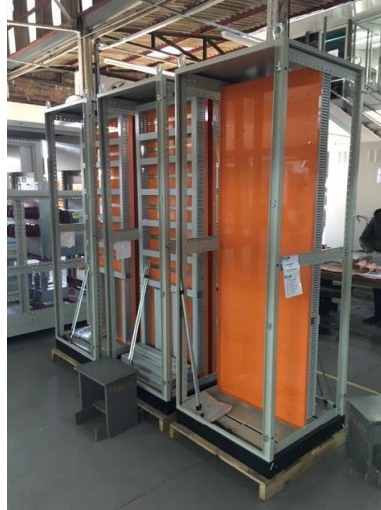
Figura 5 – Montagem Do Fundo.
