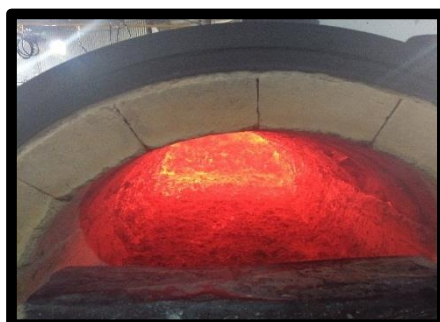
Figura 07 – Exemplo de forno de fusão de alumínio a óleo.
