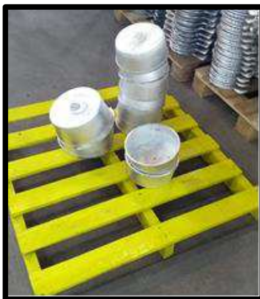
Figura 10 – Peças com defeito segregadas.
