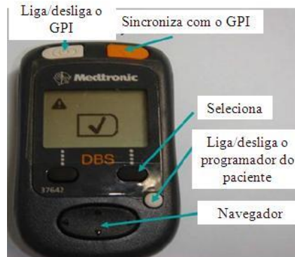
Figura 5 – Dispositivo programador do paciente (modelo 37642, Medtronic Co.) Utilizado para controlar e monitorar o neuroestimulador implantado. Fonte: ITAKURA, 2015.
