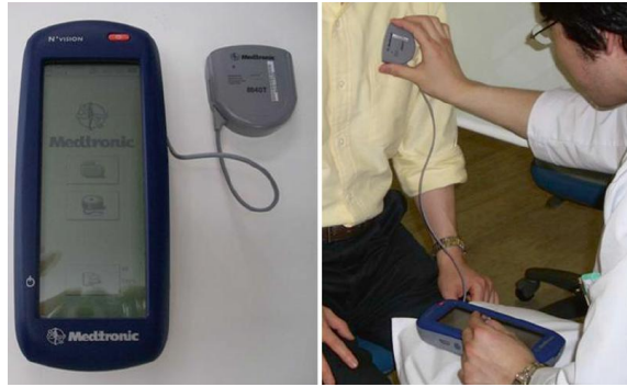
Figura 4 – Programador clínico remoto N'Vision (modelo 8840, Medtronic Co.) O programador clínico é utilizado para programar e revisar os parâmetros de estimulação, bem como, limitar as funções disponíveis no dispositivo de controle do paciente. Fonte: ITAKURA, 2015.
