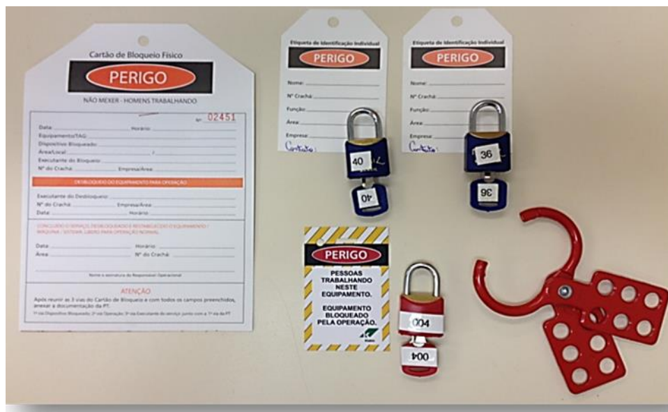
Figura 9 – Cartões de bloqueio e cadeados para situações onde mais de uma equipe de manutenção atuará sobre um único equipamento. Fonte: Procedimento interno da empresa
