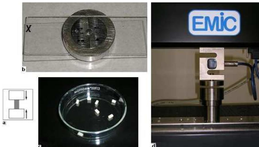
Figura 40. - a) Esquema de forças de compressão; b) Molde de aço inox para o ensaio de resistência a compressão; c) Espécimes preparados para análise; d) Ponteira da Máquina Universal de ensaios para a análise de resistência a compressão.
