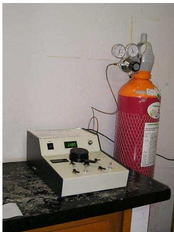
Figura 42 . -Pícnômetro a gás ( *Multipycnometer Quantachrome Instruments*).
