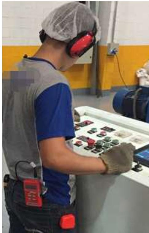
**Figura 3: Medições de níveis de ruído em Operador de Extrusora.**
