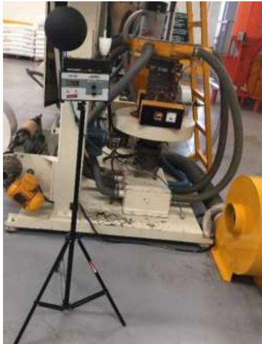
**Figura 4: Medidor de stress térmico digital.
