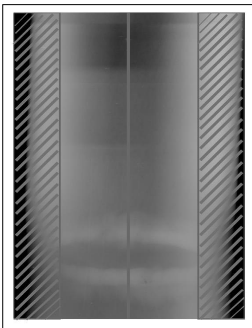
Figura 20 - Representação do espaço de busca. A região tracejada é a parte não válida da imagem e a partir do traço no meio são considerados 30% para cada lado.
