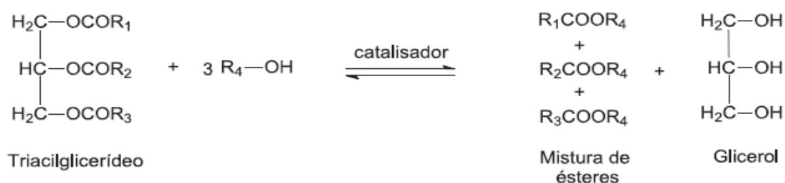
Figura 8 - Equação geral de transesterificação de um triacilglicerídeo Fonte: Geris et al. , 2007
