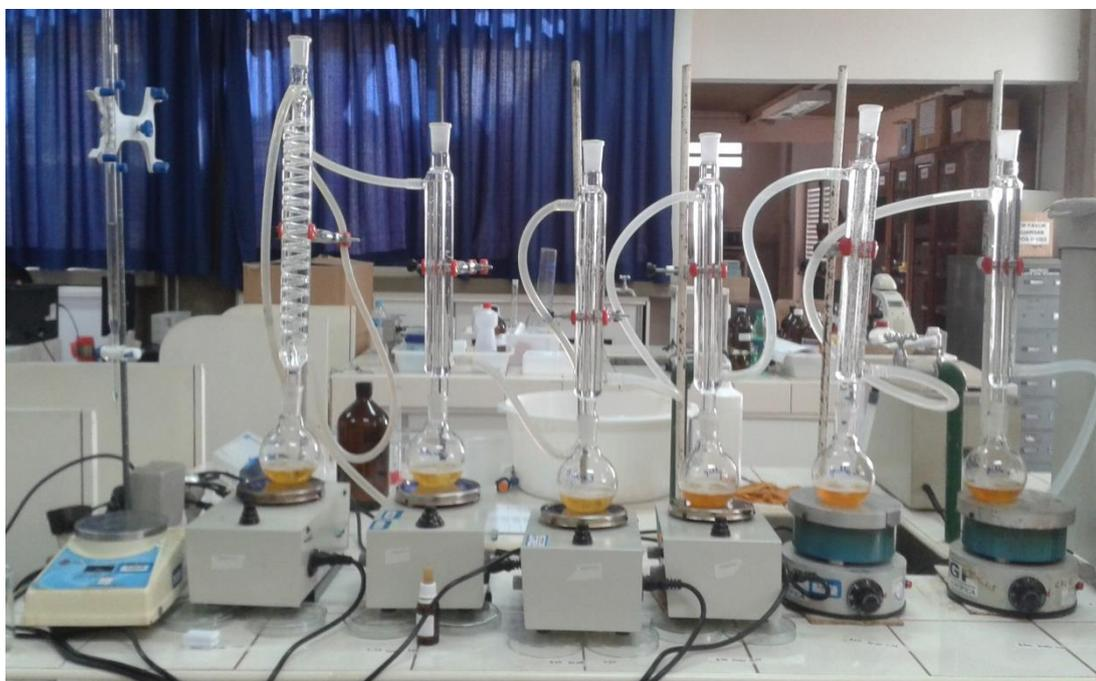
Figura 4 – Sistema de aquecimento com condensação para índice de saponificação.
