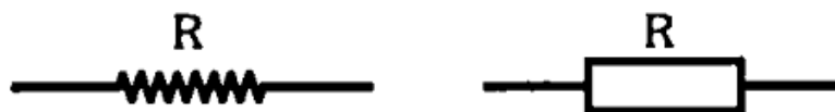
Figura 5 – Símbolo resistência elétrica Fonte: Circuitos Elétricos Corrente Contínua e Corrente Alternada Otavio Markus
