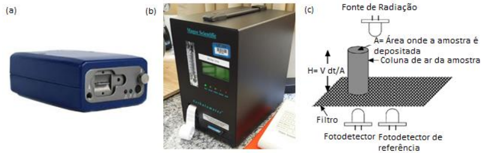
Figura 2- (a) MicroAeth modelo AE51 FONTE: AETHLABS, 2015. (b) Aetalômetro modelo AE42. FONTE: AUTORIA PRÓPRIA. (c) A coluna de ar da amostra é depositada sobre o filtro no tempo \Delta t , em seguida a fonte de radiação é usada para medir a atenuação e assim obter a concentração de BC, o fotodetector de referência é utilizado para medir as diferenças entre as variações da intensidade da radiação. FONTE: ARNOTT et al. (2005).
