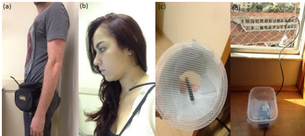
Figura 4- (a) Voluntário usando o MicroAeth na cintura. (b) MicroAeth próximo a zona de respiração. (c) Tubo de amostragem com o funil de plástico fechado na base com um tule de tecido. (d) Instalação do MicroAeth na casa dos voluntários.
