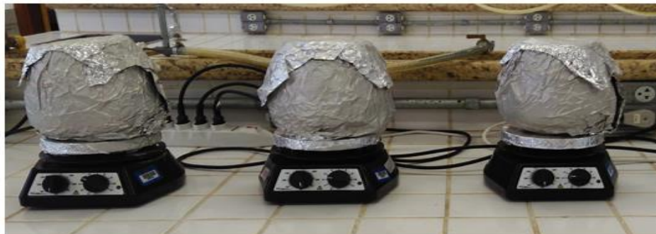
Figura 32 - Sistema de simulação de tanque de armazenamento de fluido de corte
