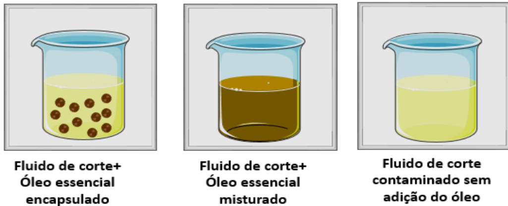
Figura 16 - Representação esquemática do teste de eficiência de aplicação do óleo essencial
