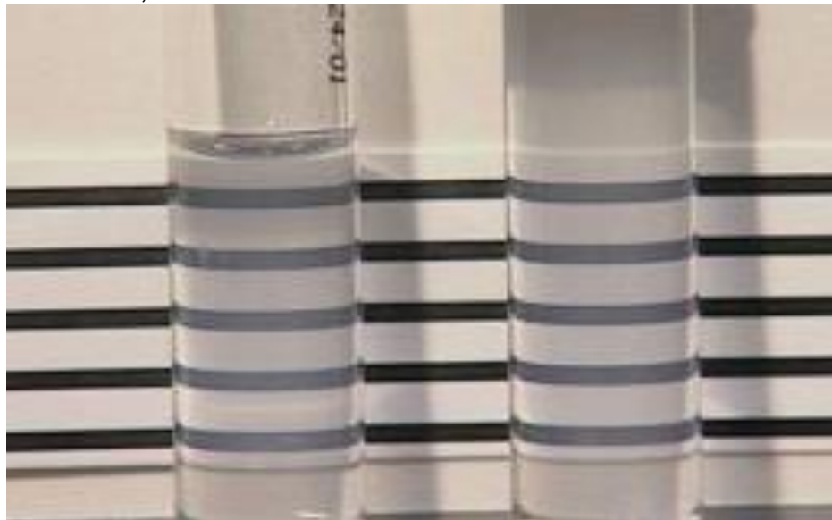
Figura 12 - Comparação da turbidez da suspensão bacteriana preparada com o padrão de turbidez de 0,5 da Escala McFarland .
