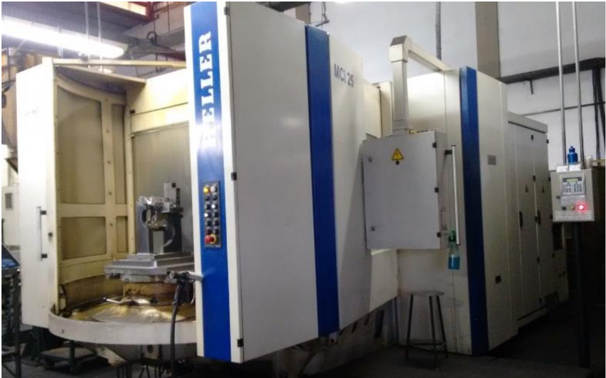
Figura 7 - Máquina utilizada para coleta de fluido de corte, centro de usinagem HELLER MCI25.
