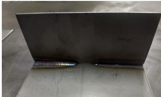
Figura 3 - Posicionamento dos cordões de soldagem.
