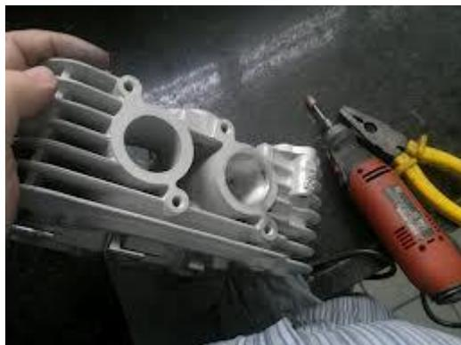
Figura 9 – Limpeza de peças utilizando ponta montada.
