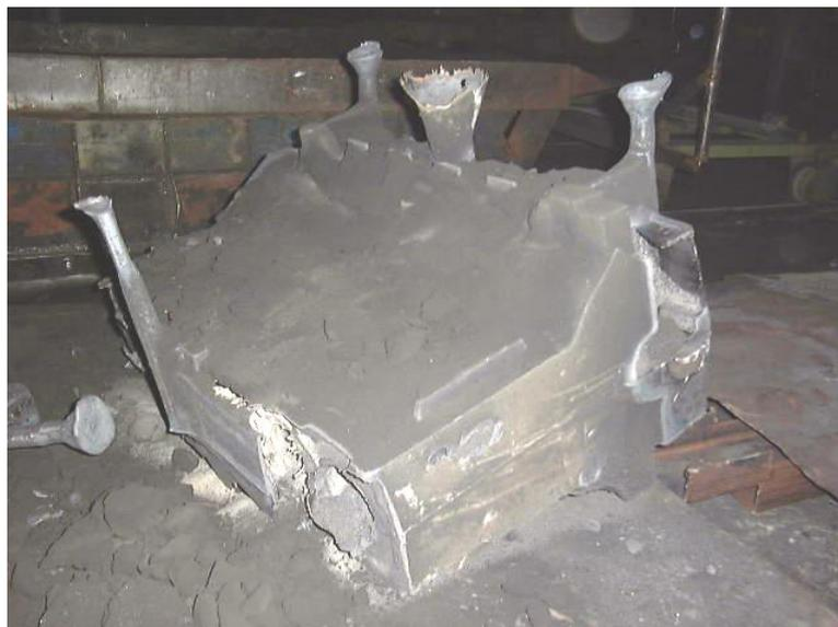
Figura 2 – Desmoldagem de peça em areia à verde.
