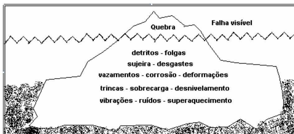
Figura 1: Falhas na Manutenção.
