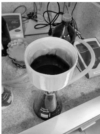
Funil de cerâmica com papel filtro e erlenmeyer tipo Kitasato utilizado na filtragem dos extratos com vácuo. Laboratório de Química Orgânica da Universidade Federal da Fronteira Sul, Campus de Laranjeiras do Sul (PR). Fonte: do autor, 2015.
