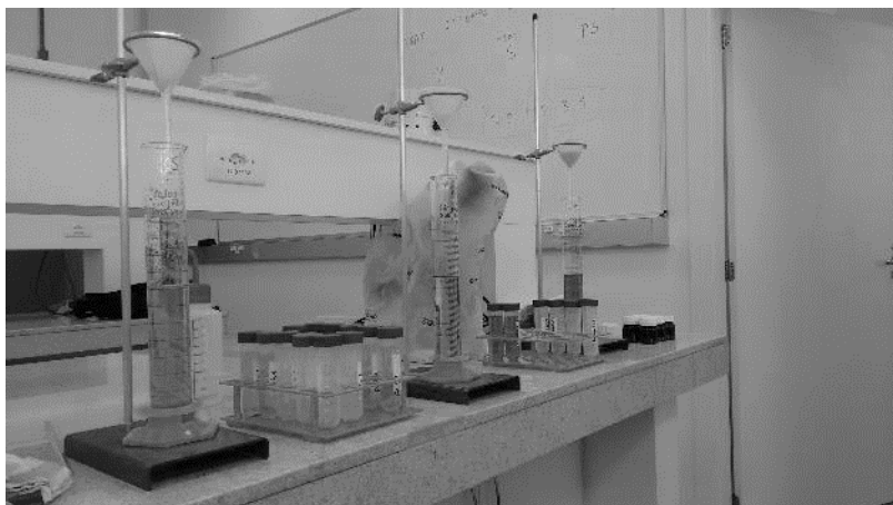
Filtragem em papel filtro do extrato aquoso do material degradado. Laboratório de Fisiologia Vegetal da Universidade Federal da Fronteira Sul, Campus de Laranjeiras do Sul (PR). Fonte: do autor, 2015.
