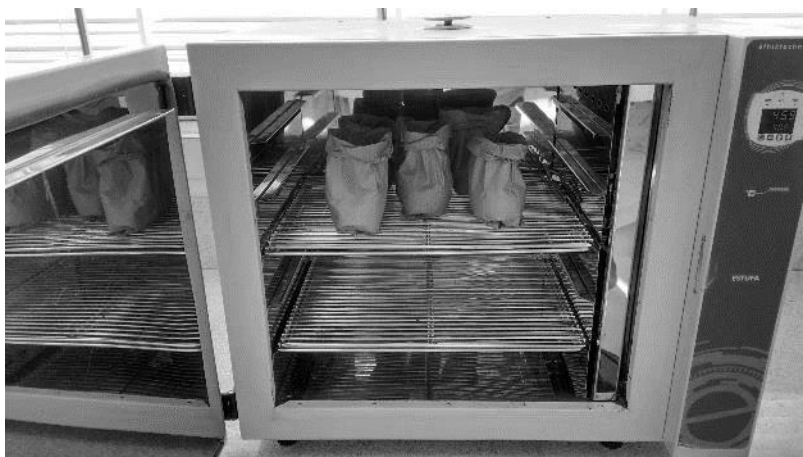
Estufa com circulação de ar forçada microprocessada, modelo 400 marca Ethiktechnology para secagem de parte aérea de capim-annoni-2 e solo. Laboratório de Fisiologia Vegetal da Universidade Federal da Fronteira Sul, Campus de Laranjeiras do Sul (PR). Fonte: do autor, 2015.
