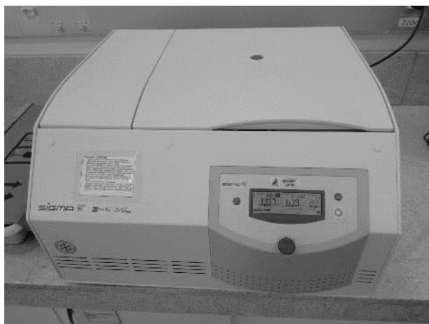
Centrifuga modelo 3-16KL marca Sigma® utilizada nos processos de centrifugação dos extratos. Laboratório de Fisiologia Vegetal da Universidade Federal da Fronteira Sul, Campus de Laranjeiras do Sul (PR). Fonte: do autor, 2015.
