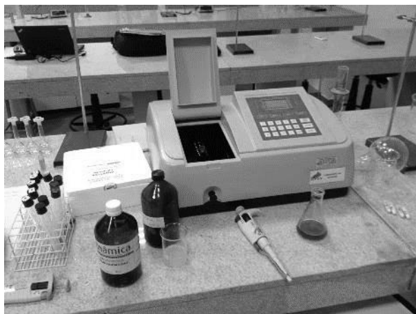
Espectrofotômetro modelo 1600UV marca Nova utilizado para quantificação de fenóis totais. Laboratório de Química Orgânica da Universidade Federal da Fronteira Sul, Campus de Laranjeiras do Sul (PR). Fonte: do autor, 2015.
