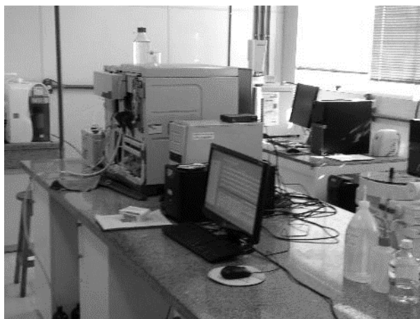
Cromatógrafo líquido modelo 920-R6 marca Varian® utilizado para identificação e quantificação de compostos nas amostras. Central de Análises da Universidade Tecnológica Federal do Paraná, Campus de Pato Branco (PR). Fonte: do autor, 2016.
