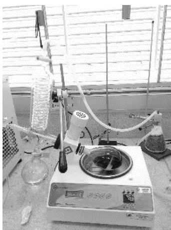
Evaporador rotativo utilizado para remoção de solvente em vácuo. Laboratório de Química Orgânica da Universidade Federal da Fronteira Sul, Campus de Laranjeiras do Sul (PR). Fonte: do autor, 2015.
