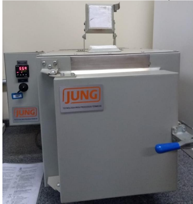
Figura 8 – Forno Mufla com controlador automático de tempo e temperatura.
