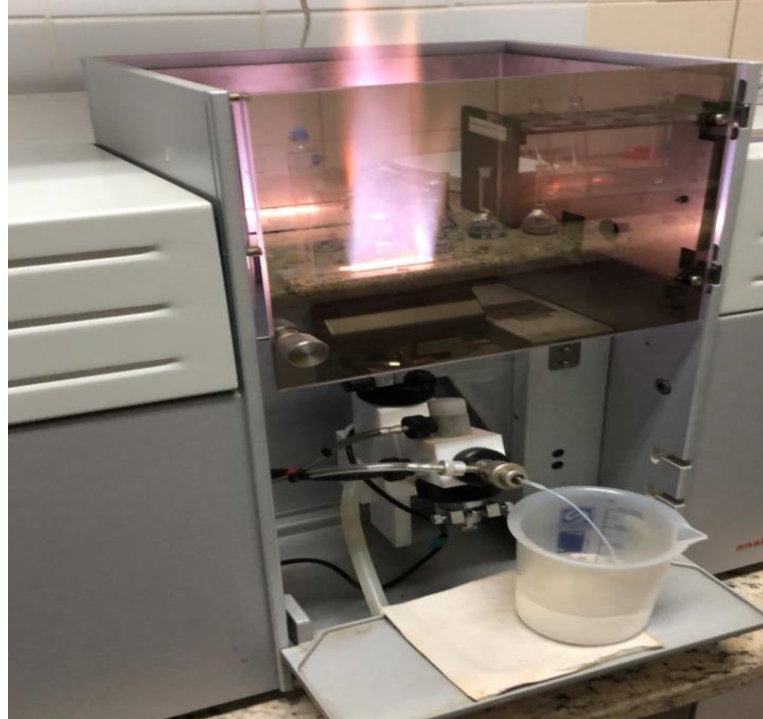
Figura 9 – Equipamento de Espectrofotometria de Absorção Atômica durante medição das amostras.
