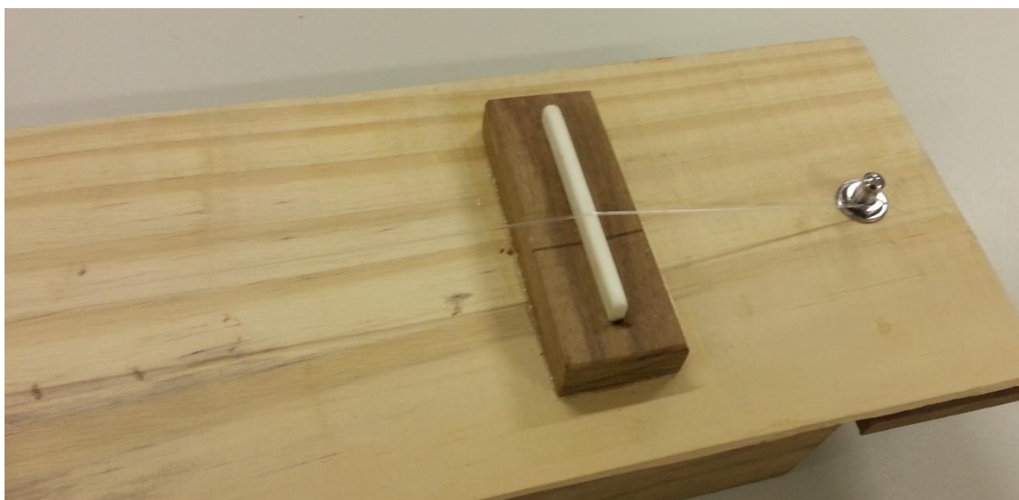
Figura 10 – Monocórdio em detalhe: Tarraxa de afinação e cavalete superior com rastilho Fonte: Do autor
