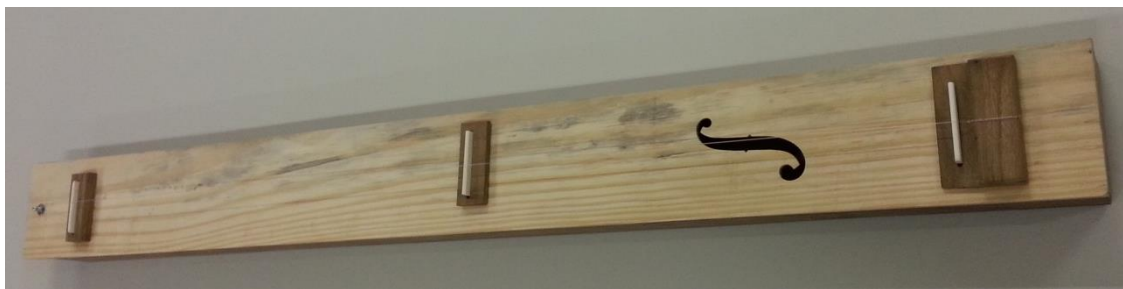
Figura 7 - O Monocórdio de Pitágoras com tampo em Pinus de baixa densidade em corte radial Fonte: Do autor
