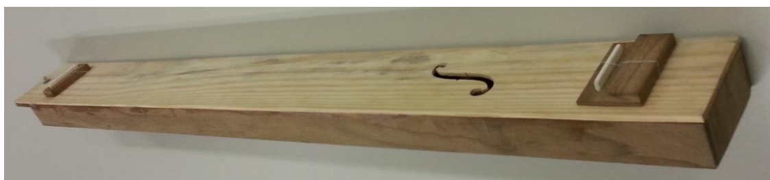
Figura 8 – A caixa de ressonância do monocórdio em madeira de Cabreúva de Alta densidade em corte radial. Fonte: Do autor
