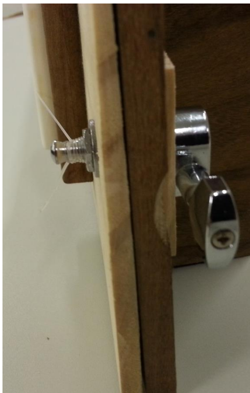
Figura 11 – Detalhe da parte posterior da tarraxa de afinação Fonte: Do autor
