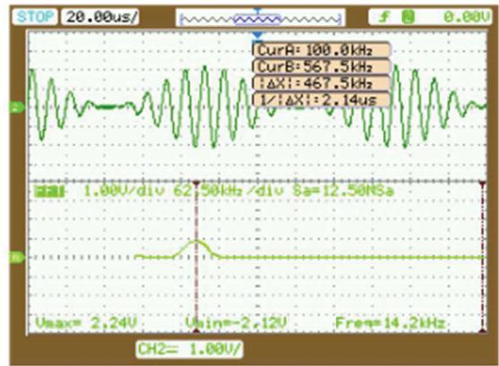
(d) FFT da modulação AM (Figura c)
