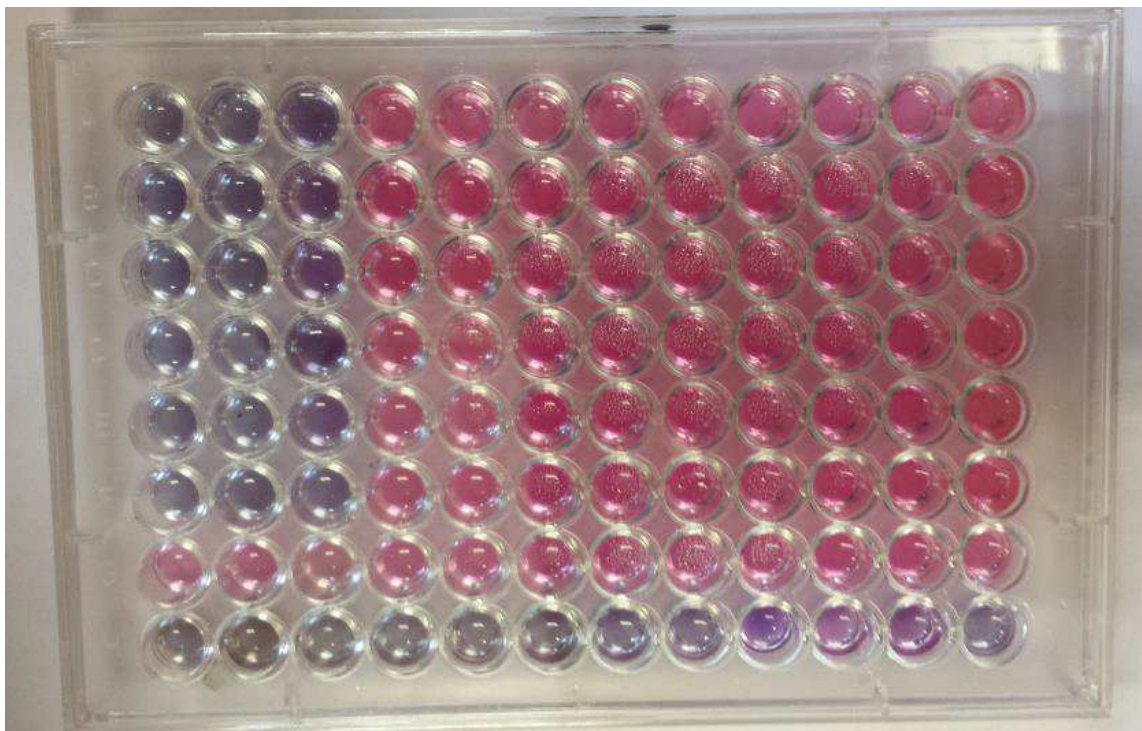
Figura 27 – Teste de Concentração Inibitória Mínima para a bactéria Pseudomonas aeruginosa INCQS 00025 para as amostras AgNP1 (linhas “A e “B”), AgNP2 (linhas “C” e “D”) e AgNP3 (linhas “E” e “F”) com controle da bactéria na linha “G”, controle de AgNP1 em “H1” e “H2”, AgNP2 em “H3” e H4” e AgNP3 em “H5” e “H6”; controle do meio de “H7” a “H12”.
