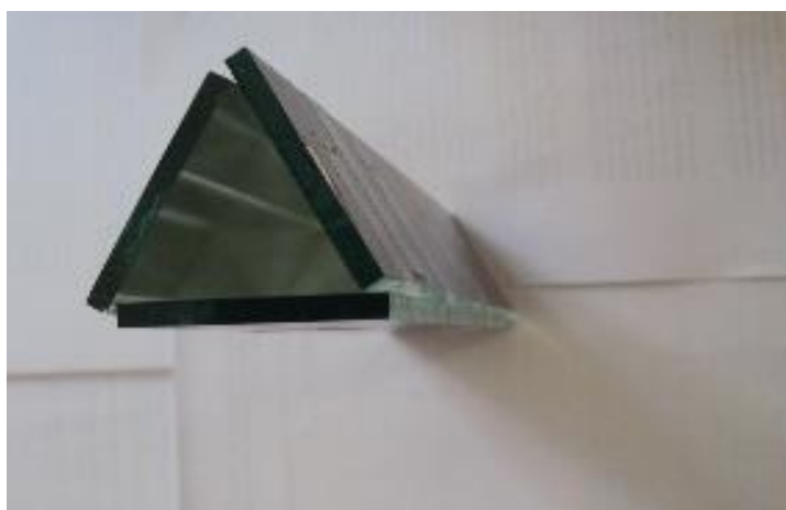
Figura 12 - Vista dos espelhos que fazem ângulo de 60° para formação do caleidoscópio Fonte: Autoria própria
