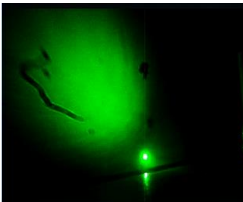
Figura 20 - Imagens de protozoários após a incidência do laser na gota de água, projeção no anteparo Fonte: Autoria própria
