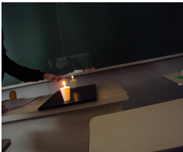
Figura 8 - Aparato de Dirck - Reflexão parcial da Luz Fonte: Autoria própria
