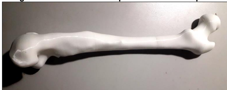
Figura 25 - Modelo físico impresso do fêmur esquerdo
