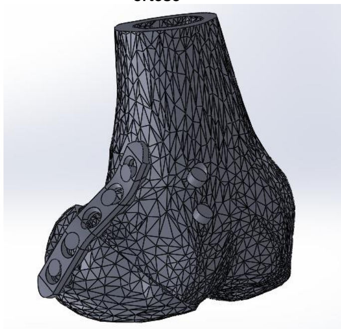
Figura 29 - Montagem dos parafusos no conjunto fêmur distal, fragmento e órtese
