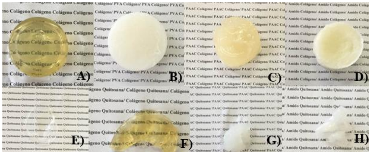
Figura 14. Hidrogéis produzidos: A) COL, B) COL e PVA, C) COL e PAACC, D) COL e AM, E) QTA, F) QTA e COL, G) QTA e PAAC, H) QTA e AM.
