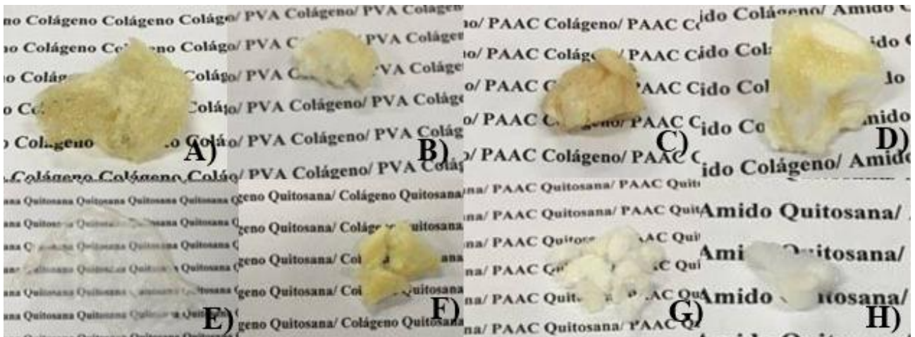
Figura 15. Hidrogéis produzidos: A) COL, B) COL e PVA, C) COL e PAACC, D) COL e AM, E) QTA, F) QTA e COL, G) QTA e PAAC, H) QTA e AM.
