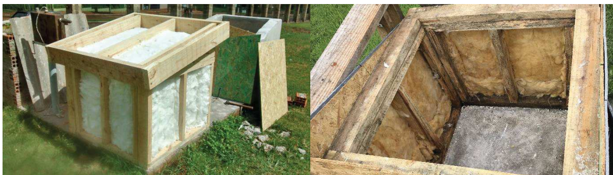
Figura 15 – Substituição do material de isolamento térmico: (a) lã de vidro antiga e (b) lã de vidro atual
