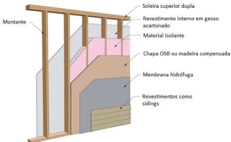
Figura 10 – Vedação e revestimentos para paredes utilizados na técnica 1
