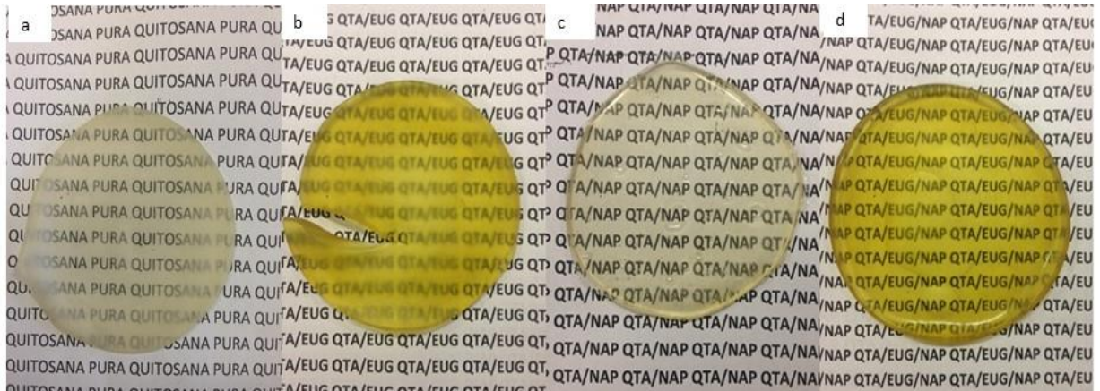
Figura 13: Fotografia dos filmes de N -acetilquitosana puro (a) e com as substâncias bioativas: (b) eugenol (QTA/EUG), (c) naproxeno (QTA/NAP) e (d) mistura de eugenol e naproxeno (QTA/EUG/NAP). Fonte: Autoria própria.
