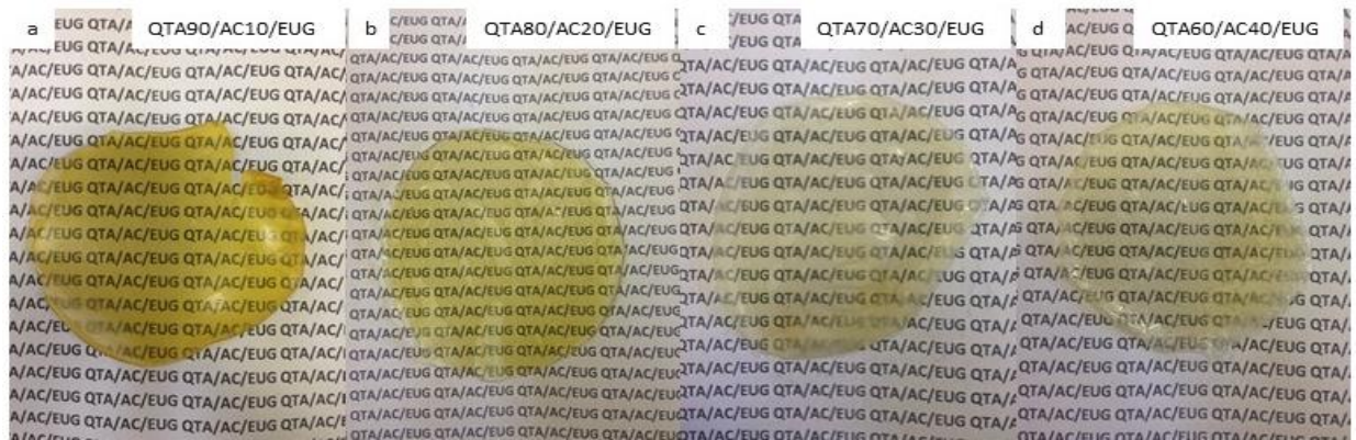
Figura 16: Fotografia dos filmes das blendas de N -acetilquitosana/Acetato de Celulose com Eugenol em diferentes proporções. Fonte: Autoria própria.
