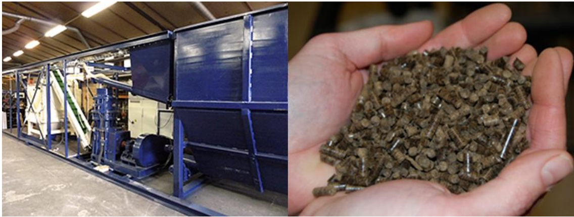
Figura 2: Máquina pelletizadora e cama de frango peletizada. Fonte: Dorset GM
