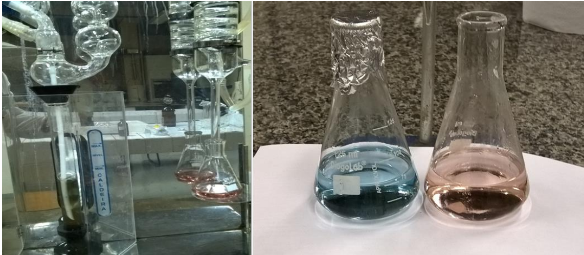
Figura 5: Destilação e Titulação para a determinação do N total. Fonte: Autoria própria
