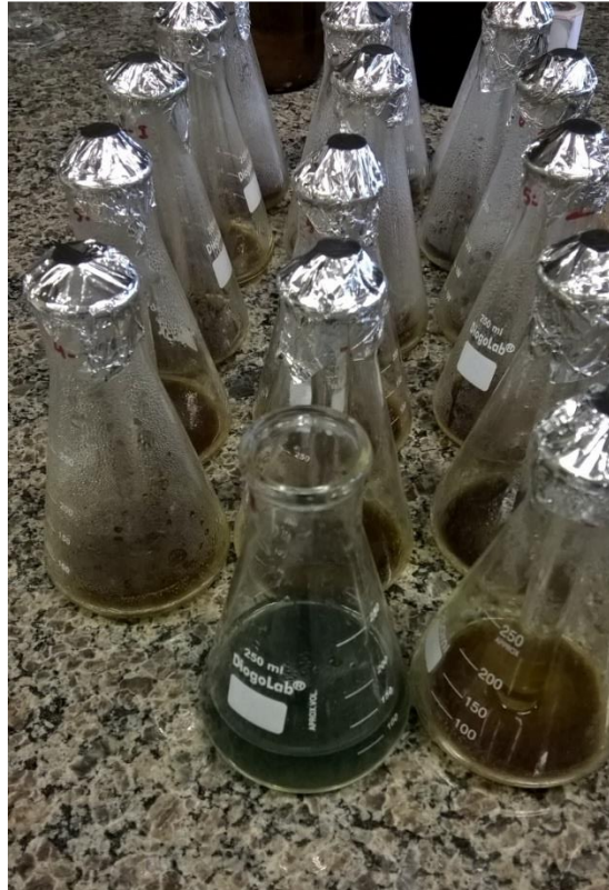
Figura 4: Variação de cor na titulação para determinação de Carbono Orgânico. Fonte: Autoria própria
