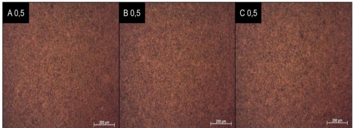
Figura 15 – Microscopia ótica da concentração de 0,5mg/ml com magnificação de 100x. Com 1 camada (A 0,5), 3 camadas (B 0,5) e 5 camadas (C 0,5).
