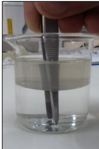
Figura 14 - Método para deposição através da interface formada de nanopartículas de óxido de níquel
