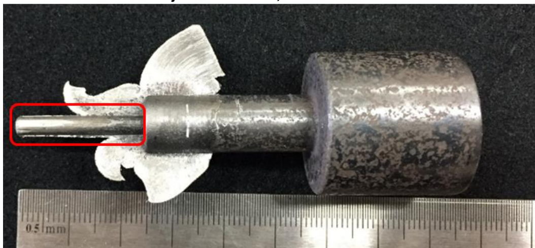
Figura 14 - Material Extrudado junto ao êmbolo, onde a área útil está destacada em vermelho
