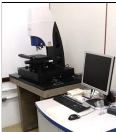
Figura 37 - Equipamento de interferometria utilizado na análise topográfica
