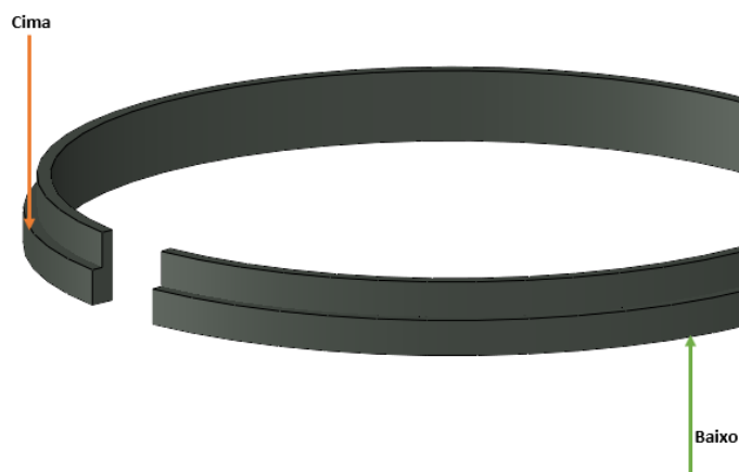
Figura 38 - Metodologia de medição de microdureza do anel raspador
