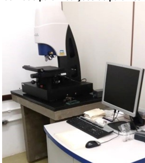
Figura 12 - Interferômetro utilizado para medições de parâmetros de rugosidades 2D e 3D
