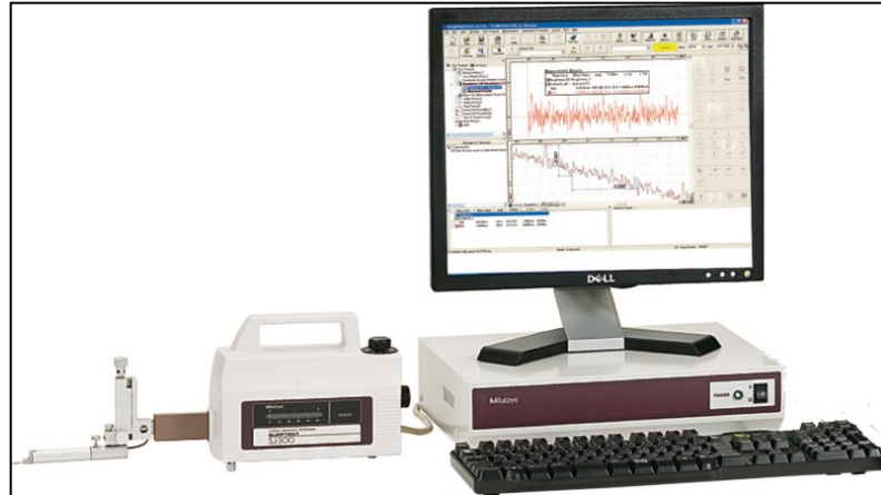
Figura 11 - Rugosímetro utilizado para medições de rugosidade 2D
