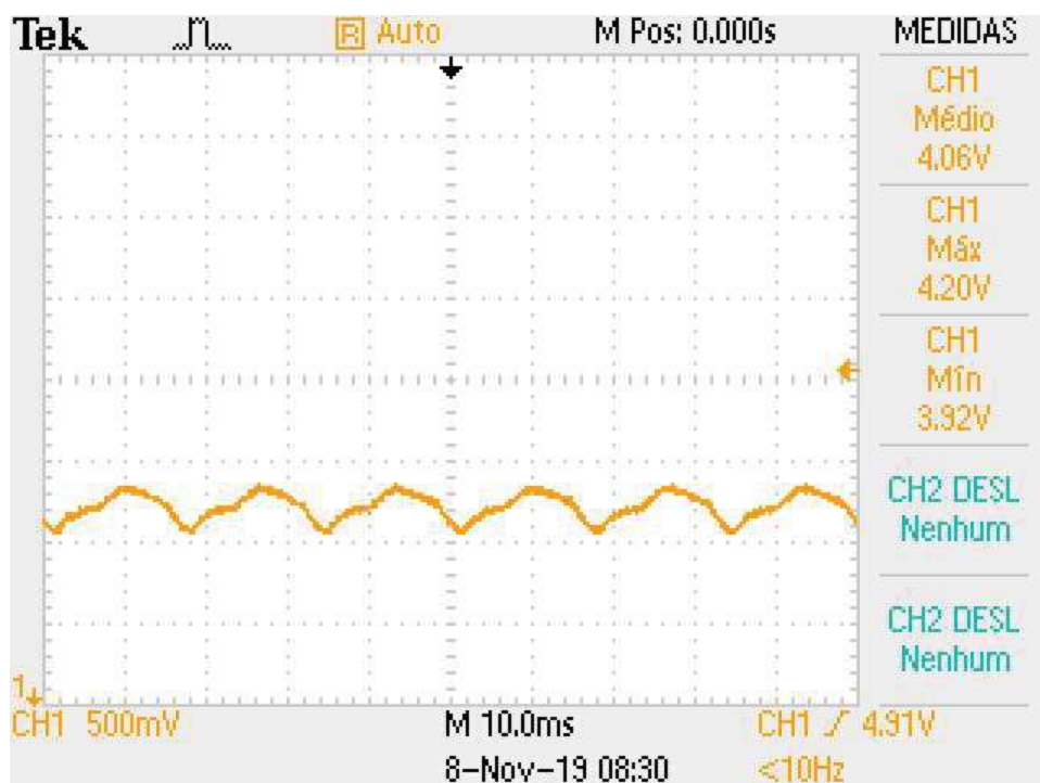
Figura 19 – Ponto de após filtro passa alta leitura no pino 3
