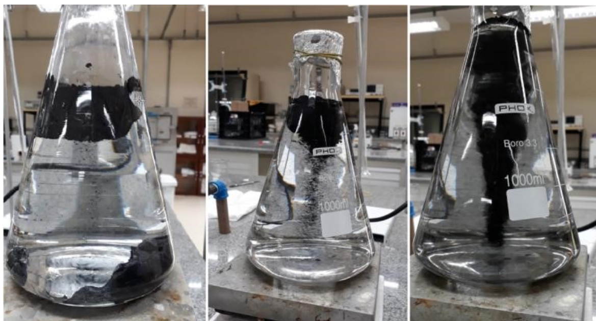
Figura 13 - Processo de desmineralização do carvão com HCl Fonte: o autor (2020).
